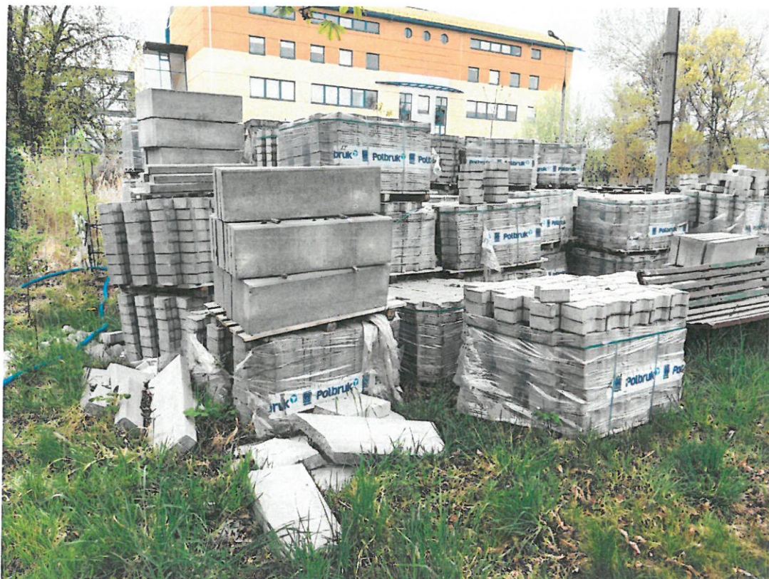
Fot. 7 Kostka betonowa na paletach oraz obrzeża betonowe
